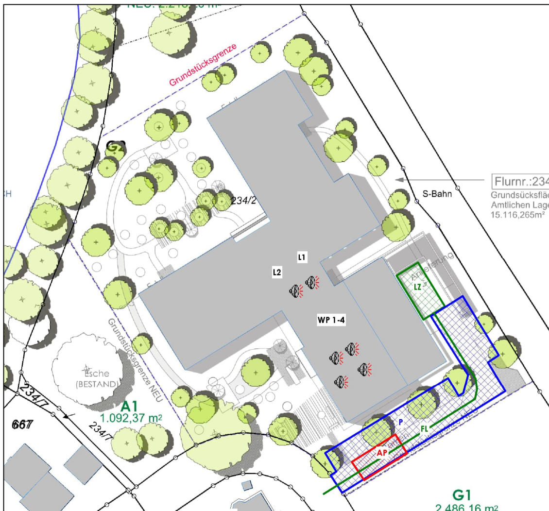
Abbildung 7: Lageplan mit Darstellung der relevanten Schallquellen – seltenes Ereignis
