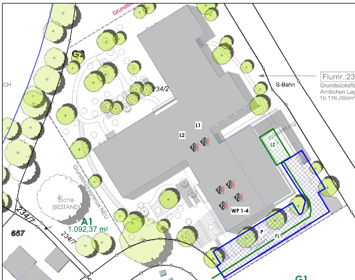
Abbildung 6: Lageplan mit Darstellung der relevanten Schallquellen – Regelbetrieb
