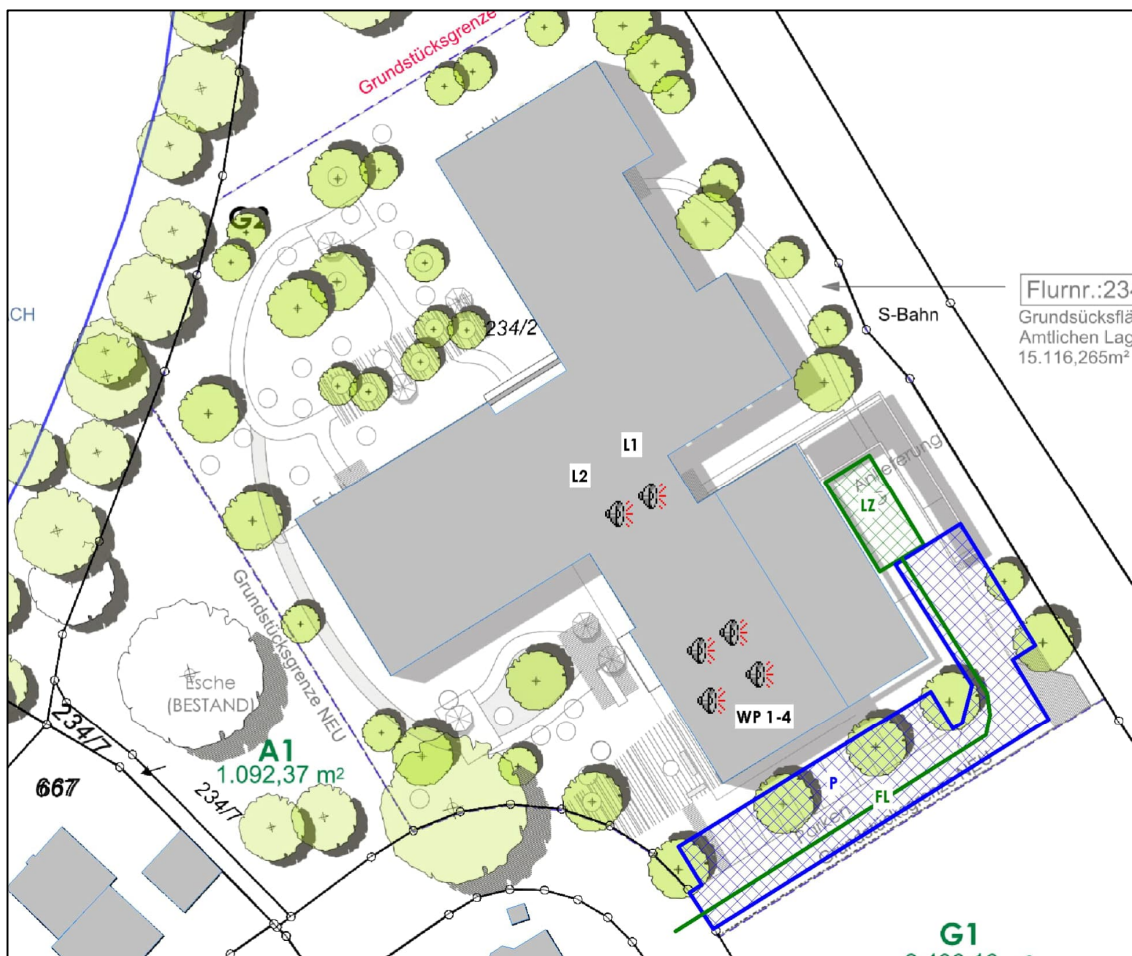
Abbildung 12: Lageplan mit Darstellung der relevanten Schallquellen – Regelbetrieb Tagzeit
