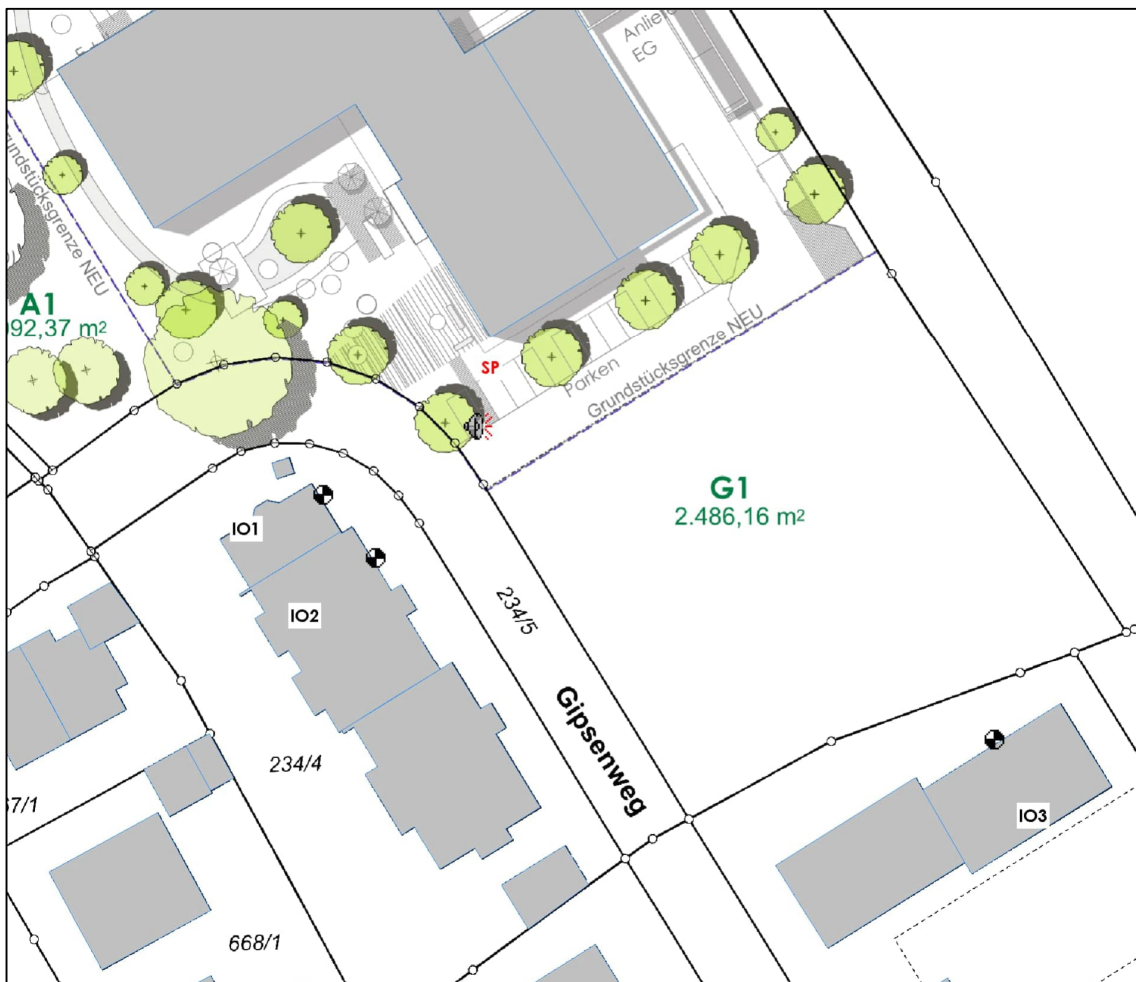
Abbildung 14: Lageplan mit Darstellung der Punktschallquelle (SP)
