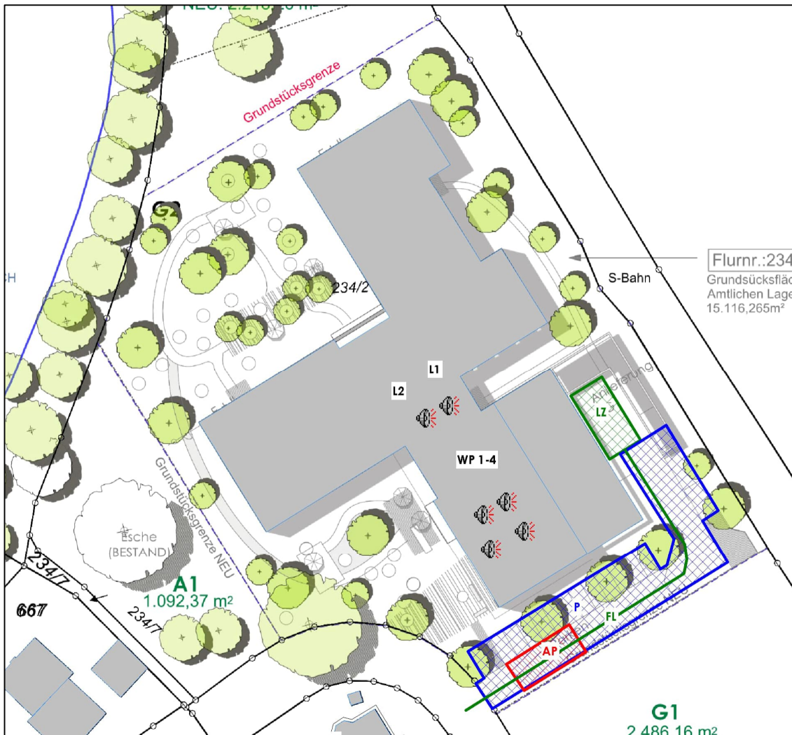
Abbildung 13: Lageplan mit Darstellung der relevanten Schallquellen – seltenes Ereignis
