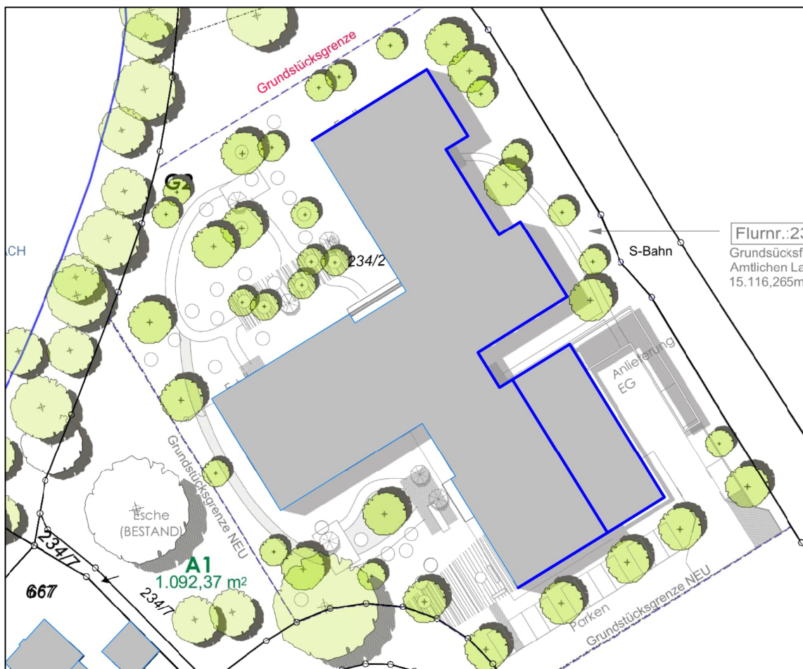
Abbildung 15: Kennzeichnung der Fassaden an denen Schallschutzmaßnahmen notwendig sind
