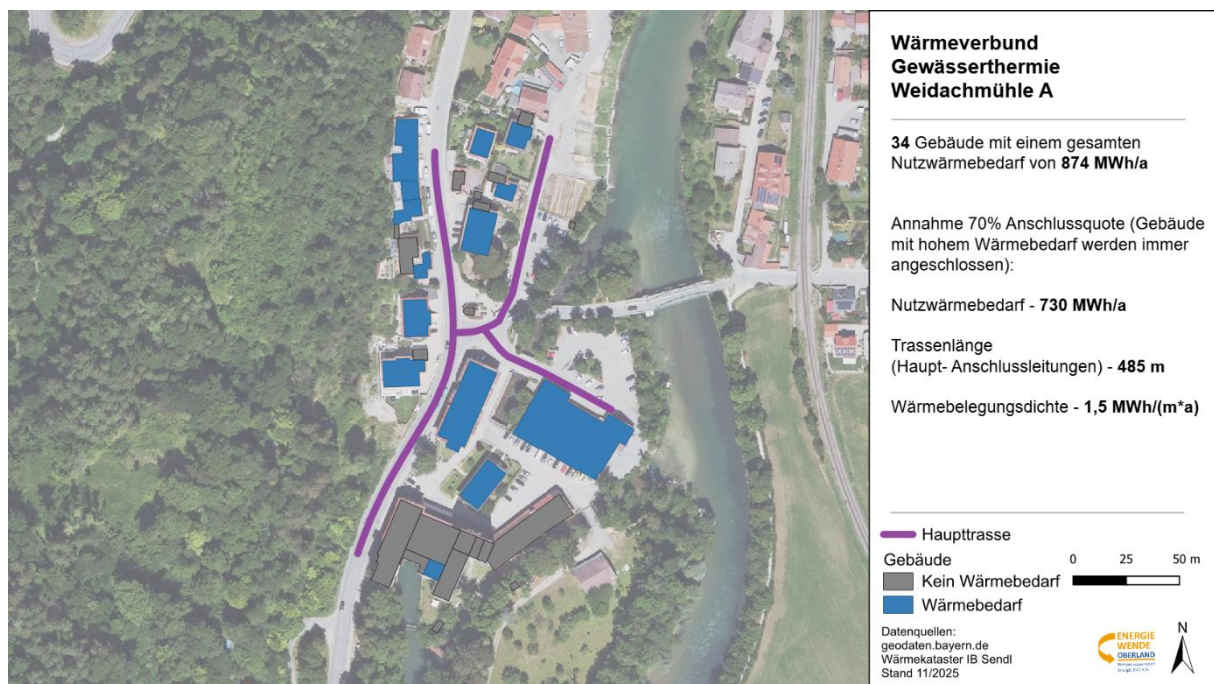
Abbildung 10-6: Wärmeverbund Gewässerthermie Weidachmühle, Ausbaustufe A
