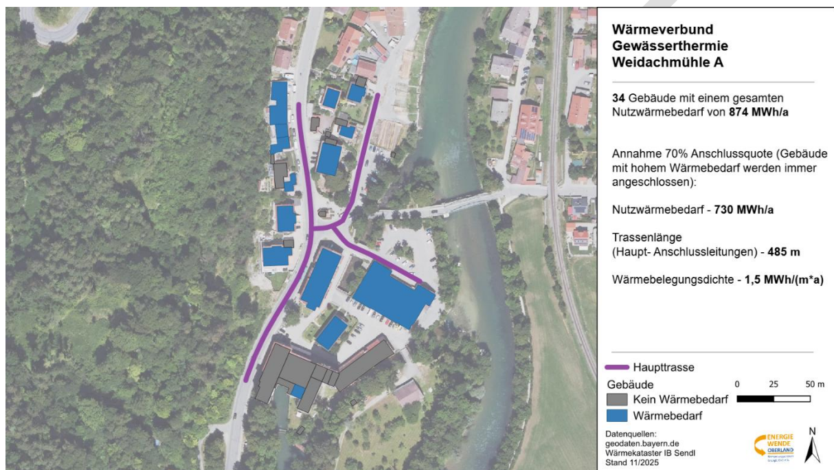
Abbildung 10-6: Wärmeverbund Gewässerthermie Weidachmühle, Ausbaustufe A
